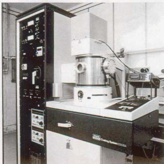
Fig. 3.1: Vue générale de l'équipement de pulvérisation cathodique Edwards ESM 100 du LMCH. L'armoire sur la gauche contient les différentes alimentations. A droite, la partie inférieure contient le groupe de pompage et la partie supérieure est la chambre de déposition.
