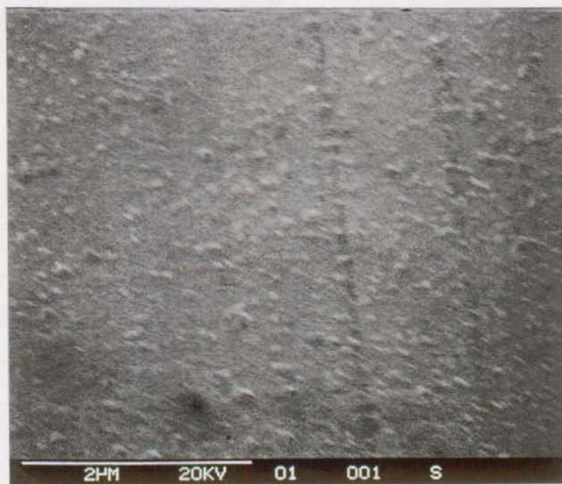
Fig. 4.12: Image au MEB d'un substrat de zinc pur non traité. Agrandissement: 20'000 x.
