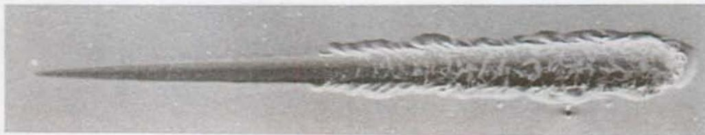
Fig. 4.53: Représentation d'une raie effectuée sur un échantillon n'ayant pas subi de traitement thermique. Longueur de la raie: 2 mm.
