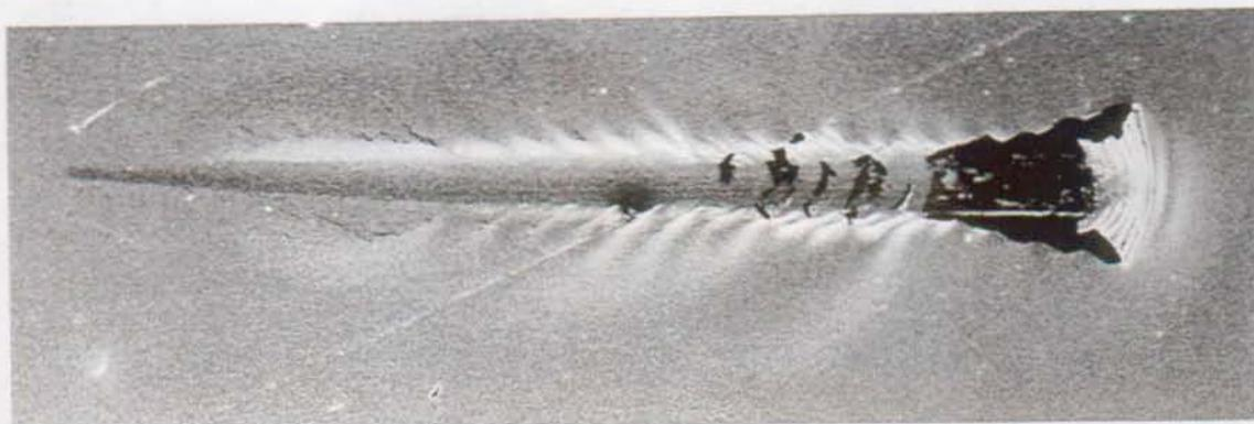
Fig. 3.6 : Vue d'une raie obtenue au microscope électronique à balayage. Cas représentatif d'une mauvaise adhésion.
