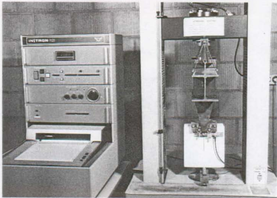
BILD 3.12: Elektrische Prüfmaschine mit der Traversenverschiebung als Kontrollparameter. (Abgebildet ist ein Keilspaltversuch mit einem Probekörper aus Gasbeton.)
