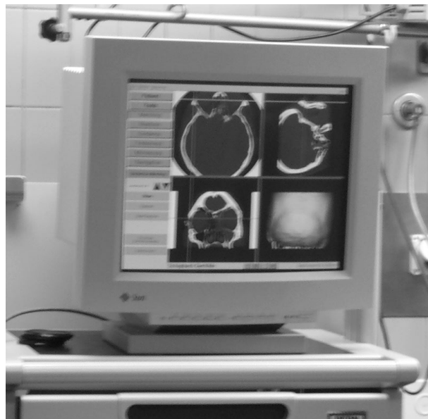
Figure 3.4 : L'écran de contrôle du système de navigation, situé à environ 1.5 à 2m du chirurgien, qui voit en temps réel le positionnement de ses outils ainsi que la vue depuis la caméra endoscopique (en bas à droite).
