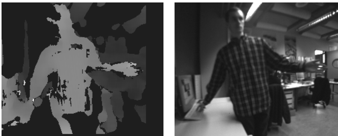
Figure 5.2 : Les 2 images acquises par la caméra. Les pixels clairs sur l'image de gauche correspondent à des distances proches. Les trous noirs montrent les zones où la distance n'a pas réussi à être calculée.
