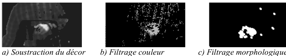
Figure 5.3 : Différentes étapes du traitement d'image initial.
