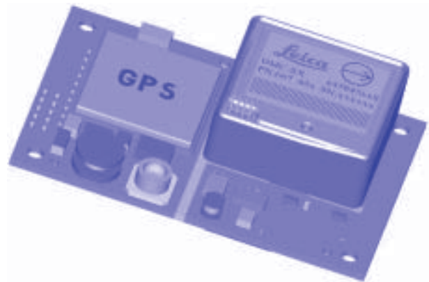
Fig. 8: le PNM (Pedestrian Navigation Module): un système de localisation tridimensionnelle miniaturisé (74 x 48 x 18 mm) complet pour moins de 50 grammes
