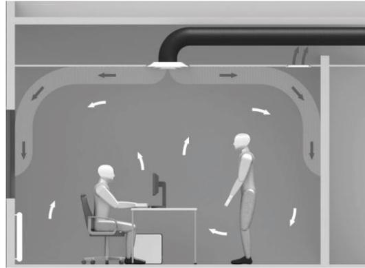
Figura 5: Sistema de ventilação utilizado em distribuição de ar misturado
