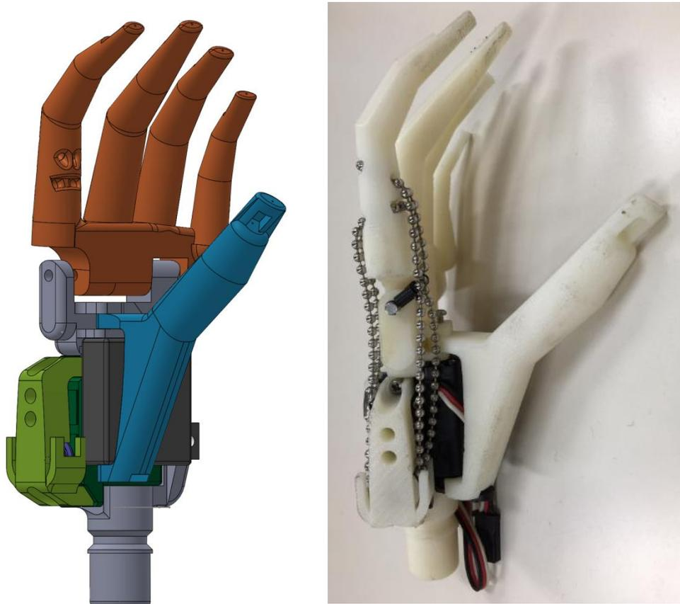
Fig. 3.26 ボールチェーン牽引腱鞘倍力機構が搭載された小児用筋電義手の CAD 図と実機写真
