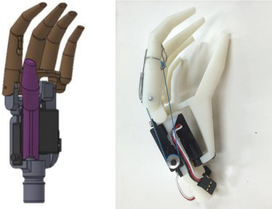
Fig. 3.7 ワイヤ牽引式倍力機構が搭載された小児用筋電義手の CAD 図と実機写真
