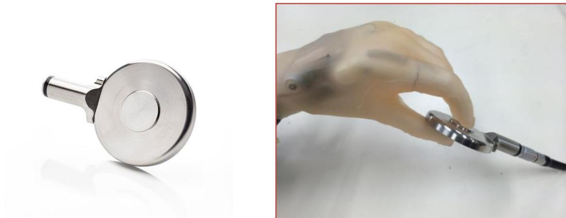
Fig. 3.8 ピンチメータの写真とピンチ力の実験シーン
