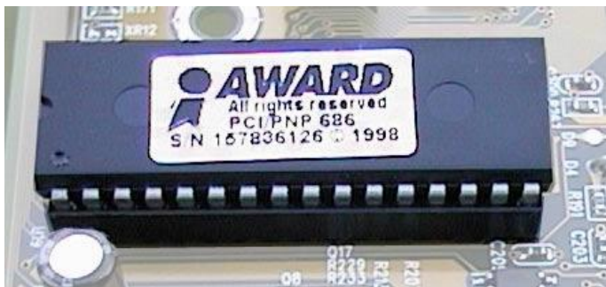
Slika 4.1.1 prikazuje nam izgled AWARD BIOS-a i izgled AMI BIOS-a na matičnoj ploči[20][21]
