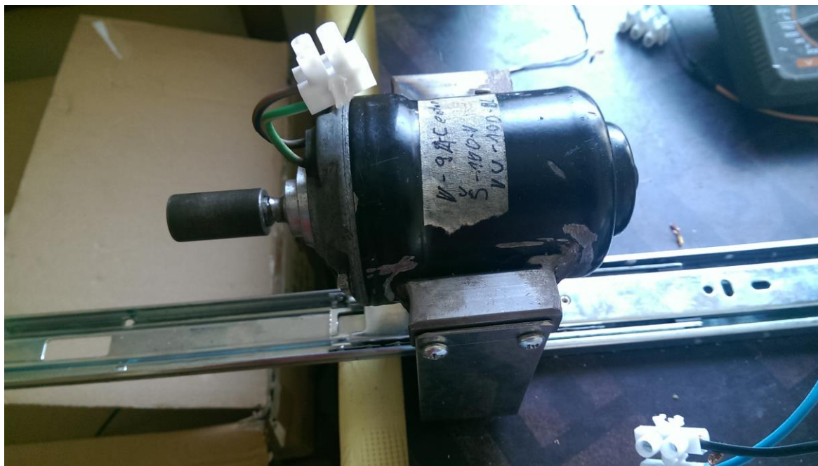
Slika 6.12. Prvi testni motor (istosmjerni) [21]
