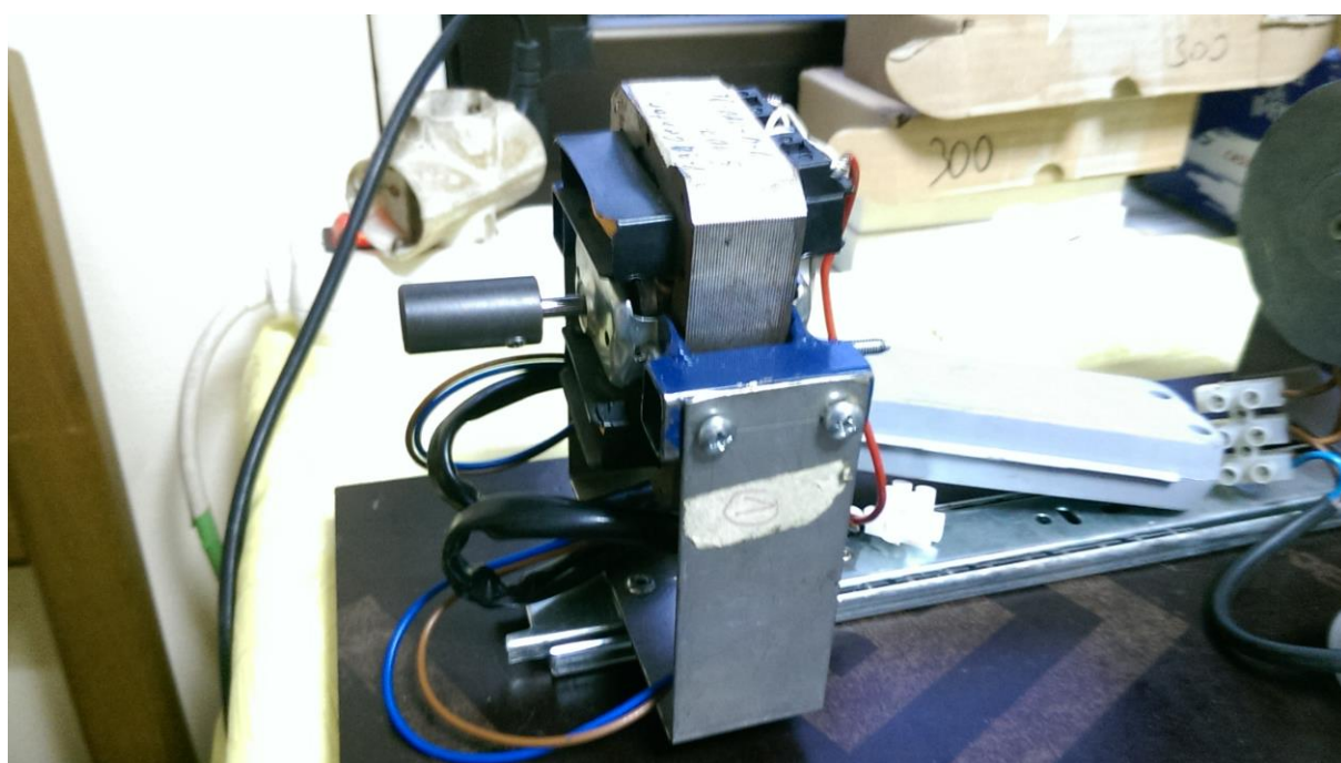
Slika 6.16. Kolektorski motor iz nape [21]
