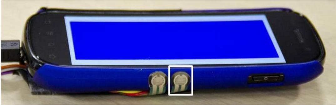
図 3.6 デバイスにかかる圧力を計測するためのセンサ
