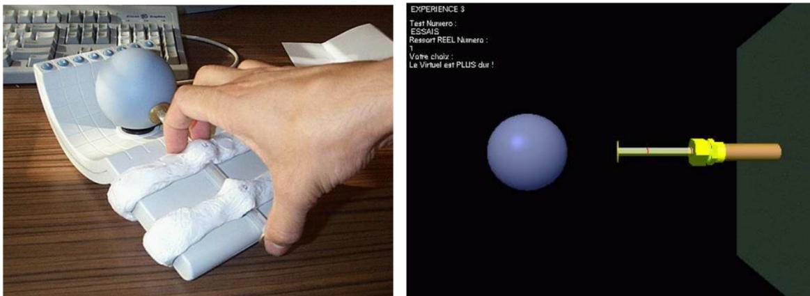
図 2.18 ピストンを用いた硬軟感提示システム
