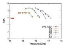
図1. 2バンドFLEXによるβ'-ETのTcの圧力依存
