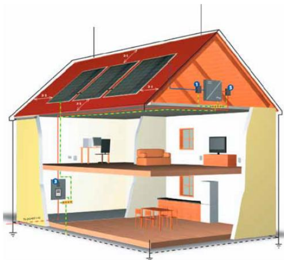
Slika 4.6. Fotonaponski sustav i gromobranska instalacija građevine [9]
