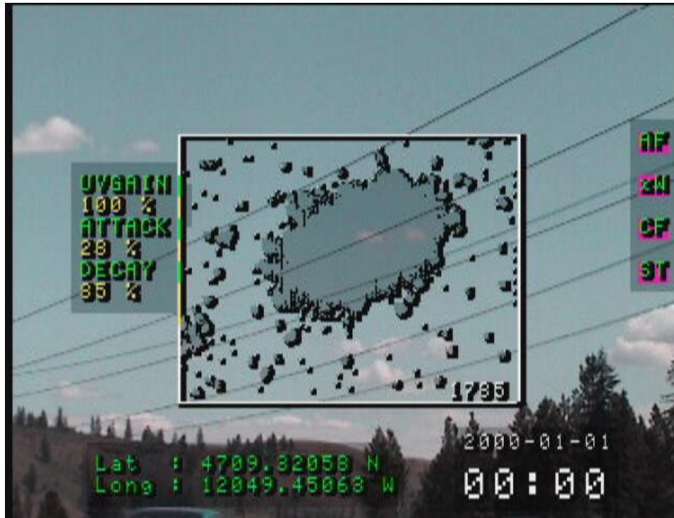
Slika 8.15. Prikaz korone između vodiča pomoću „Korona kamere“
