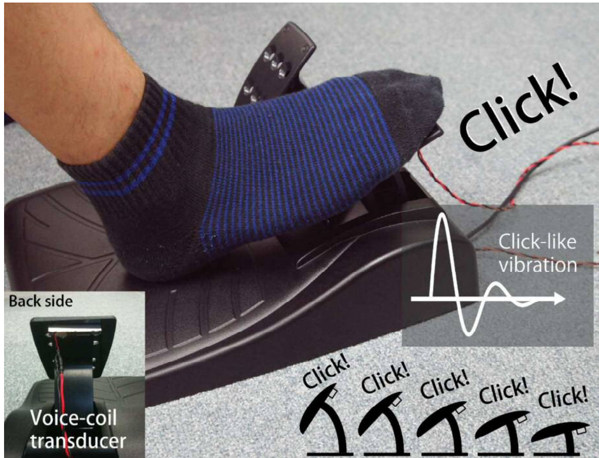
図 4-4 クリック感を付与したアクセルペダル
