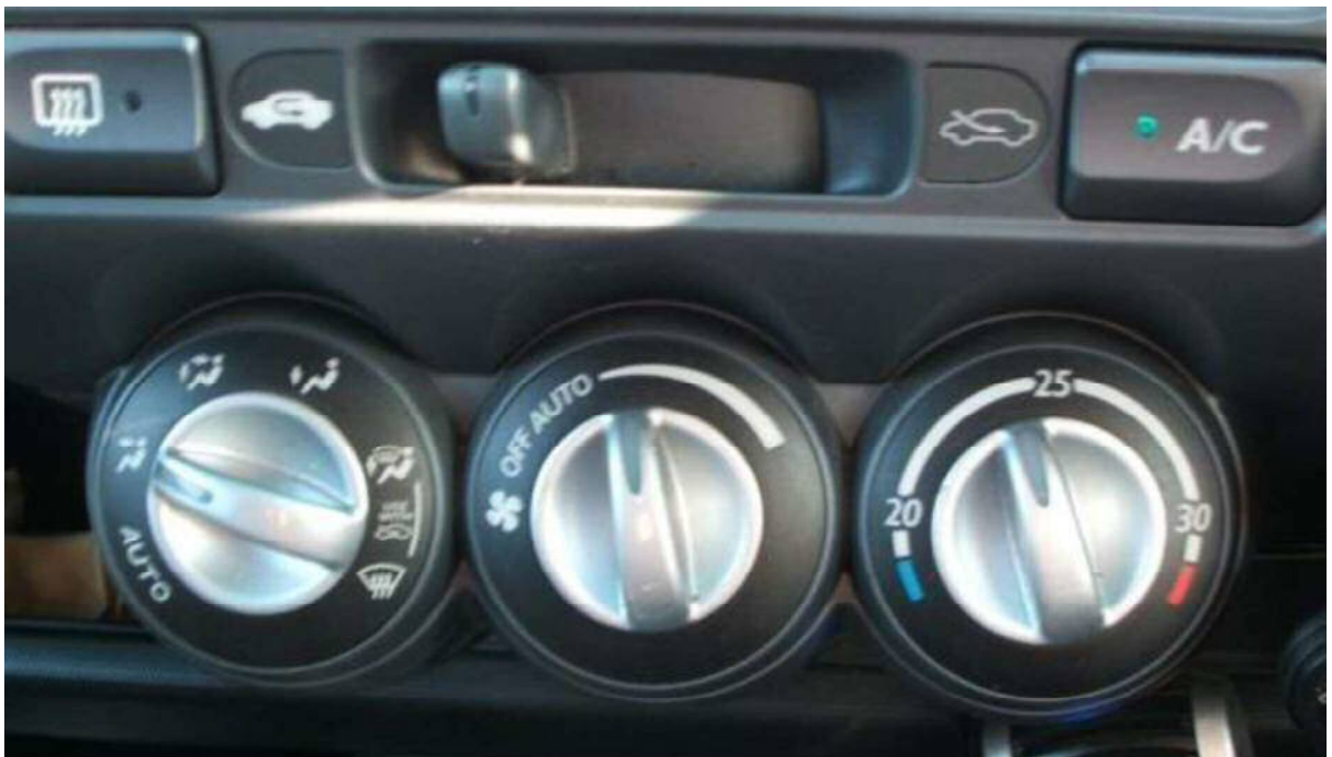
図 3-8 自動車内のダッシュボードに取り付けられたロータリスイッチ 左のダイヤルがカチカチ感を呈示するもので、離散的に抵抗感が変化する。中央および右のダイヤルはカチカチ感を呈示しないもので、抵抗感の変化はなく、常に一定である。
