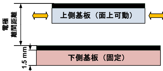
図3.4 電極離間距離の定義
