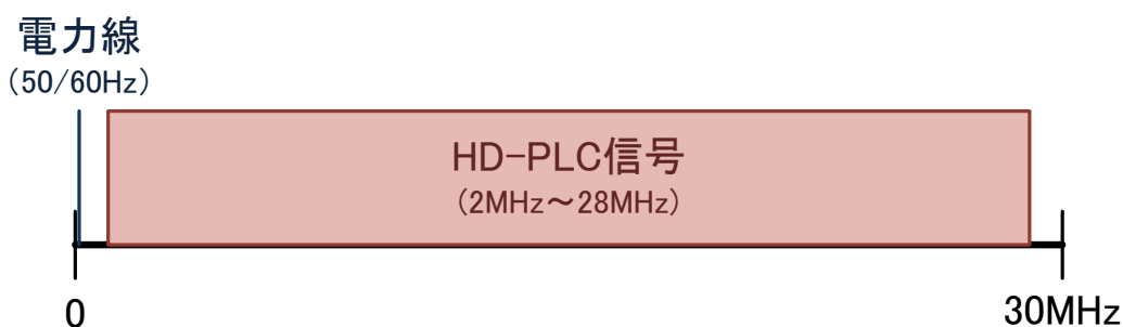
図 2.20 電力線周波数と HD-PLC 信号の周波数
