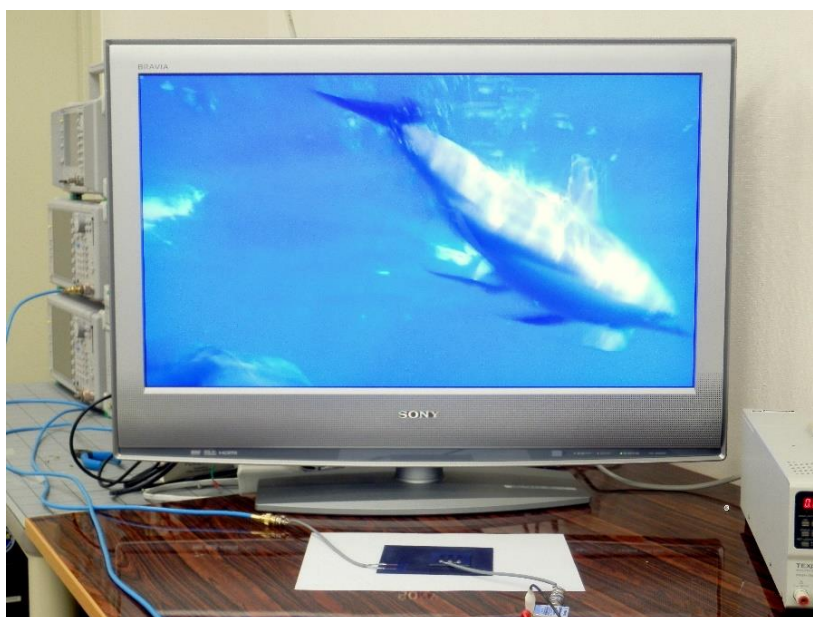
図 4.3 電界結合を用いた ISDB-T 信号伝送
