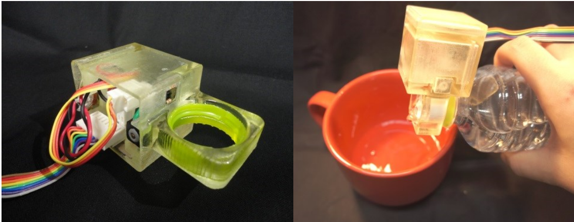
図 5-1 アタッチメント型トクトク感重畳装置： 左) 装置外観，右) ペットボトルに装着した際の様子
