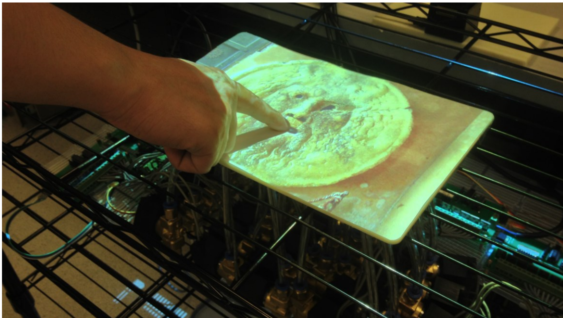
図 5-16 VacuumTouch : タッチスクリーンにおける真空圧を用いた吸引力提示装置。
