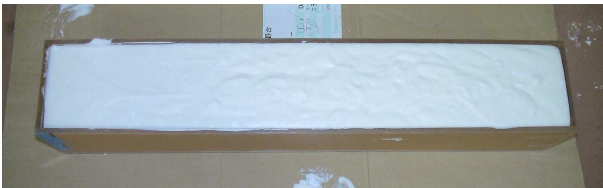
図 3.34 完成したファントム (整形前)
