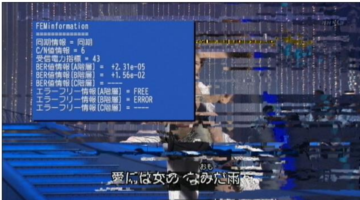
図 3.23 伝送に失敗したとき (画質劣化) の例
