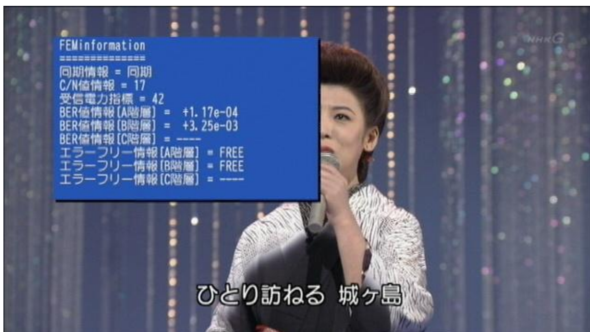
図 3.20 伝送に成功した時の復調映像 (図 3.19 の状態で伝送したとき)
