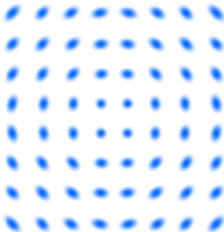
図 4-11 位相雑音がある場合の 64 QAM の受信コンスタレーションの例
