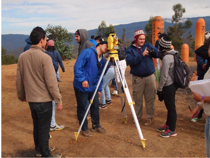
Fotografía de observación al sol para calcular el azimut real 2016
