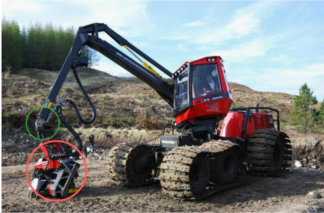
Kuva 2.2. Komatsu 931.1- hakkuukone. Hakkuulaite ympyröity punaisella. Puomin osa, josta jatkovarsi liikuu ulos, on merkattu vihreällä ( kuvan ottaja MacDhòmhnail / CC BY).
