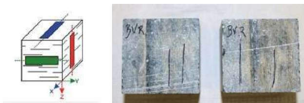
Figura 1. (A) Esquema mostrando a foliação e as direções preferenciais para a obtenção de provetes para o ensaio de expansibilidade; (B) Amostras de Ruivina cortadas segundo o corruze.
