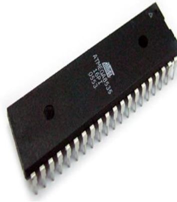
Gambar 2.14 Skema dan Bentuk Mikrokontroler ATmega8535
