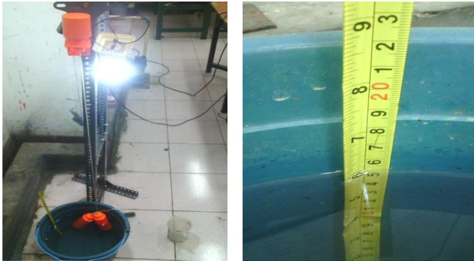
Jarak ketinggian air dalam wajan atau ember dengan ketinggian air 150 mm, mengakibatkan lampu AC menyala. Penggunaan pelampung air tidak efektif apabila diaplikasikan di penampungan air, karena jarak yang diperlukan untuk menghidupkan lampu atau pompa air yaitu 90 mm.
