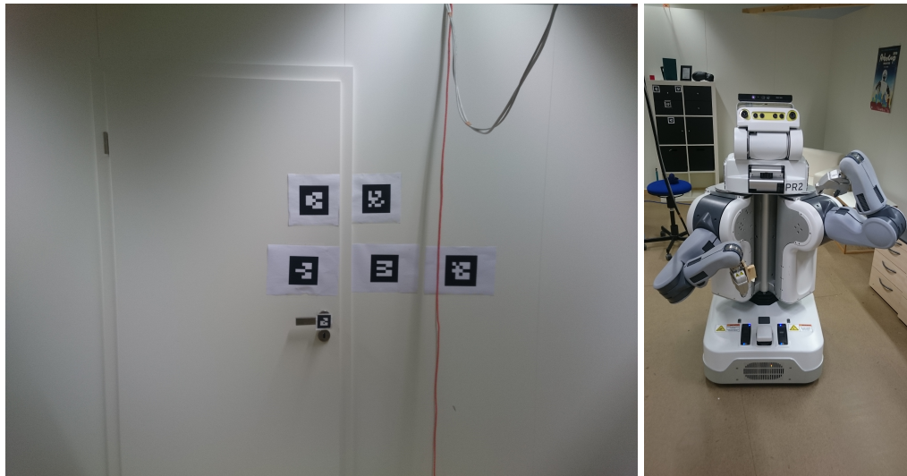
Abbildung 3.1: Links der Versuchsaufbau: Die untere Marker Reihe als Knöpfe und ein Marker an der Türklinke. Rechts: Der PR2 von Willow Garage.
