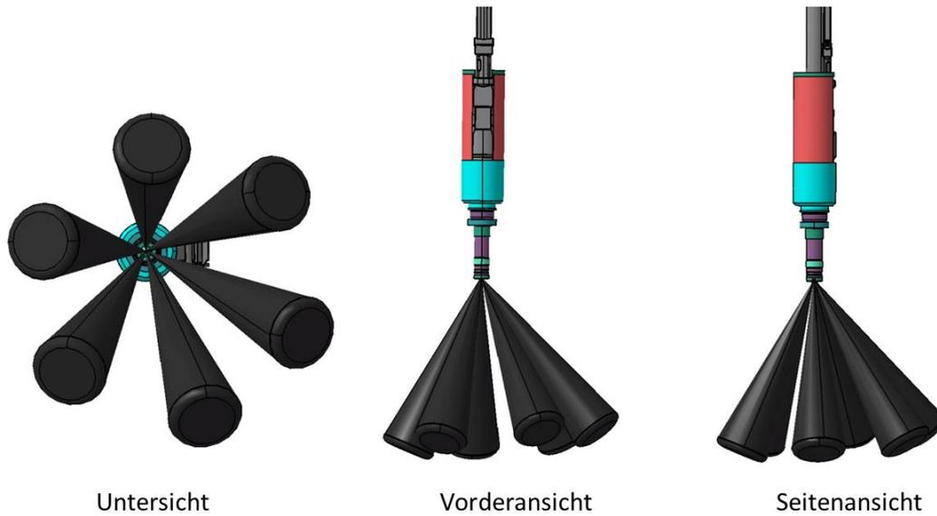
Abbildung 5.3.2: CAD Darstellung des Mehrlochinjektors
