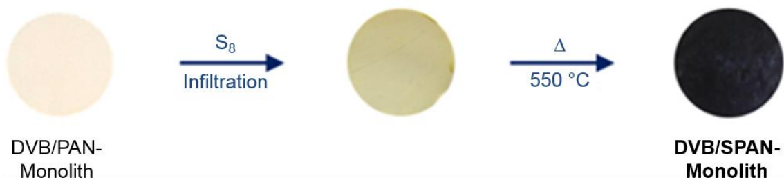
Abbildung 50: Darstellung von DVB-basierten SPAN-Monolithen.
