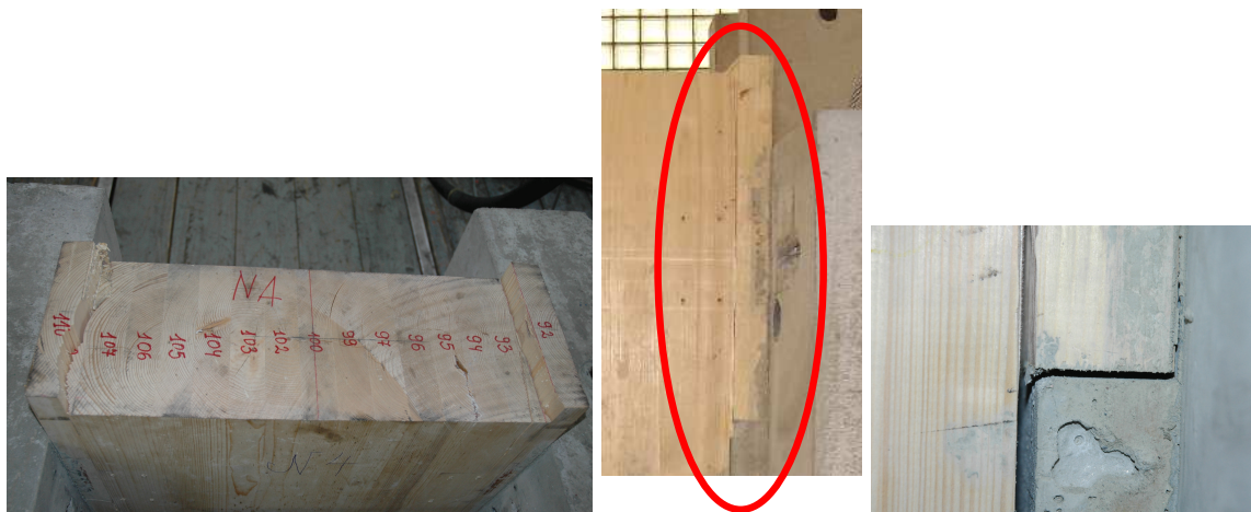
Abbildung 2.41: Abscheren des Vorholzes im Push-Out Versuch
