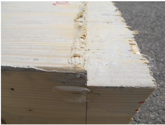
(a) Stauchung im Holz Kerbe 2 Träger 10.3
