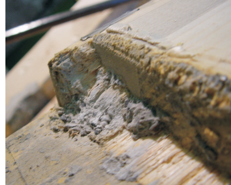
(b) Stauchung in Faserrichtung [20]
