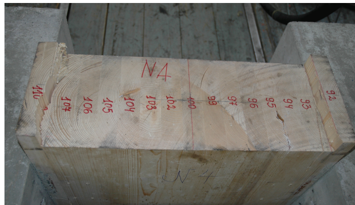
Abbildung 2.22: Abscheren des Vorholzes beim Push-Out Versuch aus Kuhlmann & Aldi [1]
