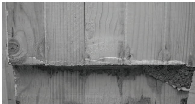
(b) Stauchung in Faserrichtung
