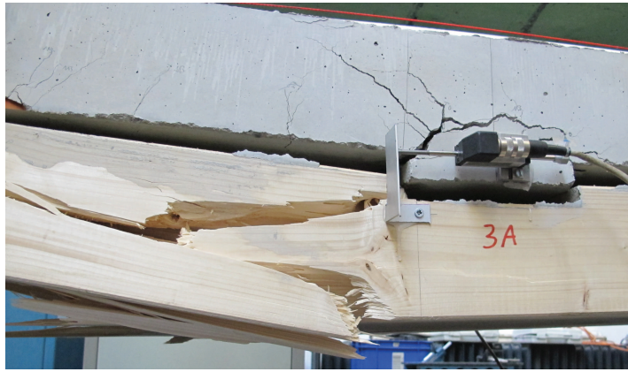
Abbildung 3.53: Biegezugversagen an Kerve 3 des Trägers 11.1
