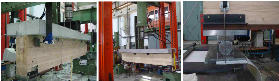
Abbildung 2.44: Verbundträger in der Versuchseinrichtung und Auflagerdetail
