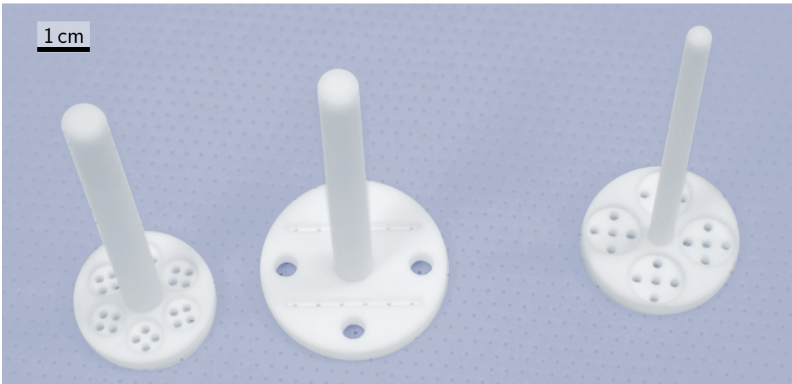
Abbildung 2.3.: Verschiedene Substrathalter aus Teflon. Bei den beiden äußeren werden die Substrate mit der polierten Seite nach oben in die sichtbaren Kavitäten gelegt, während sie bei der Ausführung in der Mitte mit der Kante in die schmalen Rillen geklemmt werden. Der linke Halter wurde letztlich für die kleinen ( 5\text{ mm} \times 5\text{ mm} ) Substrate benutzt und der in der Mitte für die Großen ( 10\text{ mm} \times 10\text{ mm} ).
