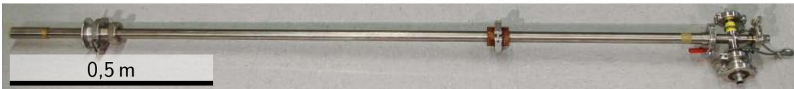
Abbildung 4.2.: Probenstab, der für die Messungen im Heliumfass verwendet wurde. Links sieht man das Ende mit dem abgedeckten Messkopf, rechts die beiden Anschlüsse für die Temperaturmessung (oben) und für den Messkopf (unten).
