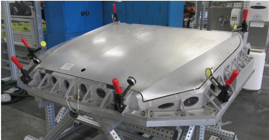
Abbildung 27: Prüflehre zur produktionsbegleiteten Bauteilbegutachtung (Übergang- und Spaltmaße) nach dem Falzen für einen Motorhauben-Zusammenbau
