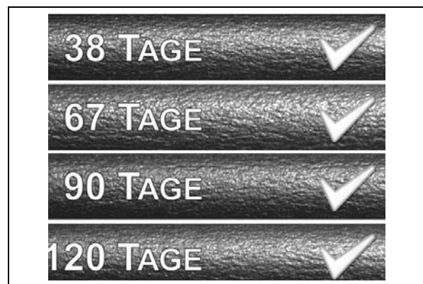
Frontalaufnahme der Biegekante der gealterten Proben nach dem Maschinenfalzen
