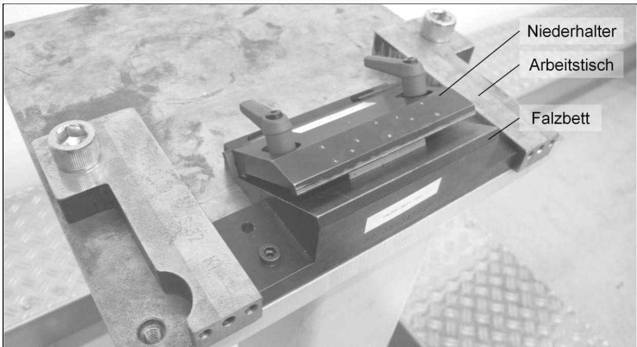
Abbildung 5-6 Versuchseinrichtung zum Rollfalzen von Aluminiumblechproben
