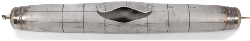
Bild 3.1: Quasistatischer Berstversuch mit einem Geradrohr D_a \times s = 114,3 \text{ mm} \times 6,0 \text{ mm}
