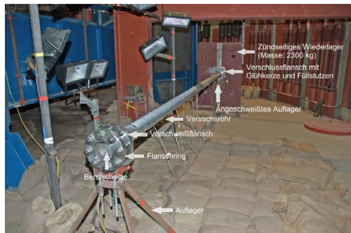
Bild 3.7: Versuchsaufbau im unterirdischen Prüfschacht KPH2 der MPA Universität Stuttgart
