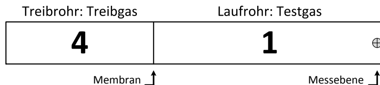
Abb. 1.1. Phase 1 des Stoßwellenexperiments: Bedingungen im Stoßrohr zu Beginn des Experiments [17].
