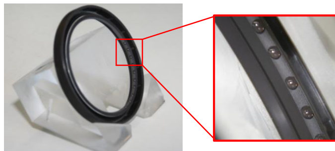
Bild 5.50: Auf ölseitiger Flanke der Dichtkante abgesetzte Tropfen [STUD06]
