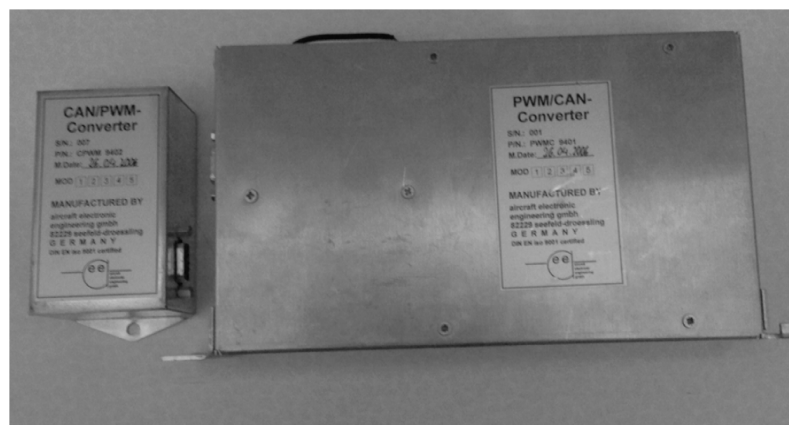
Abb. 7.3 CAN/PWM und PWM/CAN Konverter der Firma aee GmbH
