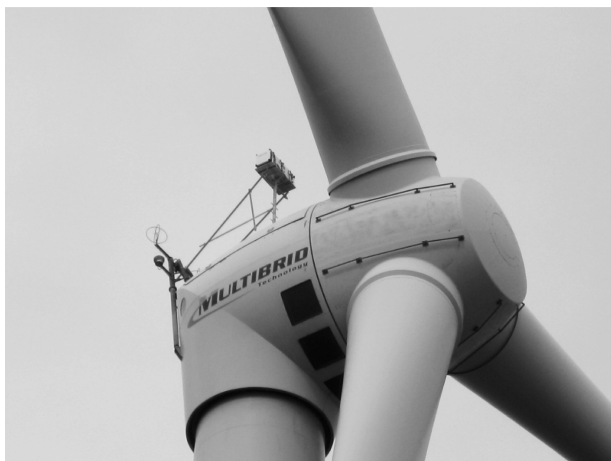
Bild 4 Ultraschallanemometer und SWE-LIDAR auf der Gondel des Prototyps AREVA M5000.
