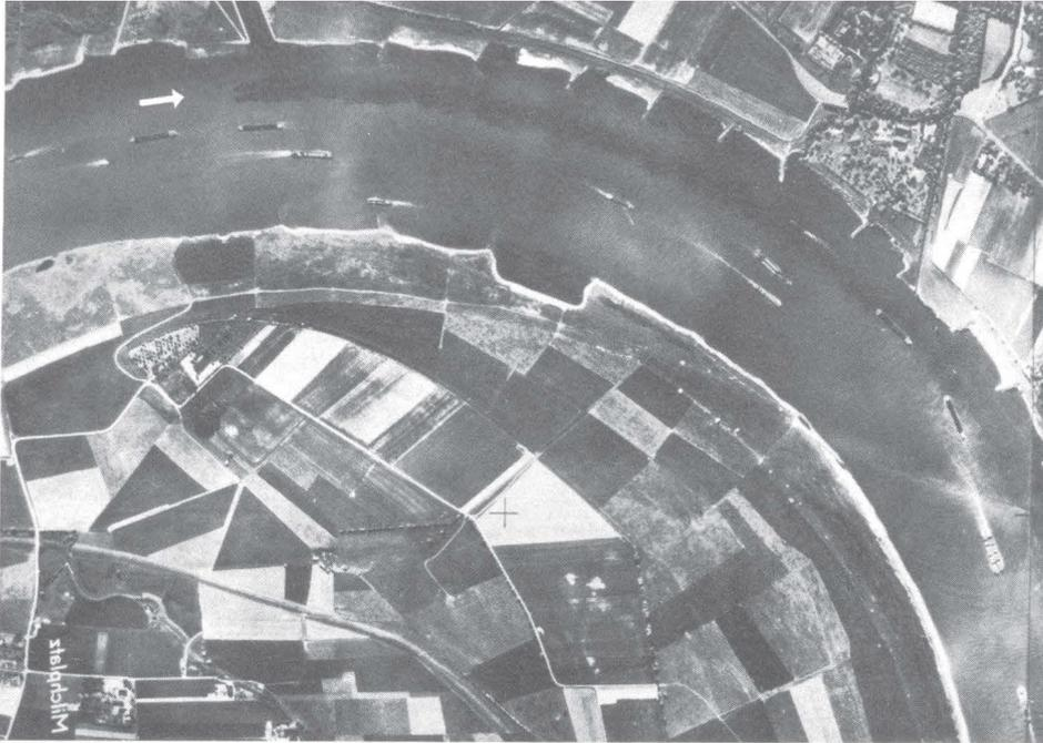
Bild 1: Abwassereinleitung (dunkel gefärbt) durch sohlverlegte Rohre in den Rhein. Die spiralförmige Sekundärströmung in Flußkrümmungen lenkt die Abwasserfahne gegen das Innen- und Außenufer ab, je nachdem, ob sie sich wegen Dichteunterschieden mehr entlang der Sohle oder der Wasseroberfläche bewegt. Fließrichtung von links nach rechts. (Photo: Hansa-Luftbild GmbH, Münster, Westfalen.)
