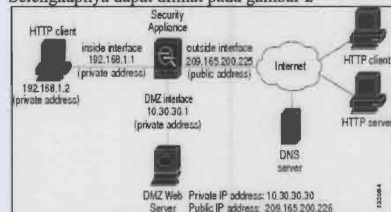
Gambar-2. Contoh Instalasi dan Konfigurasi DMZ
