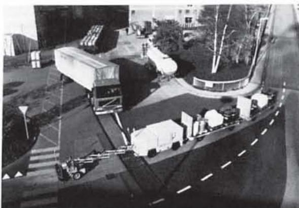
Bild 3: Schwerlast-FTS beim Überqueren einer Kreuzung mit Schienenanlagen.
