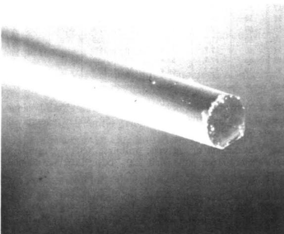
**Abb. 3** Intakte Faserendfläche, Ummantelung auf ca. 3 cm entfernt.
