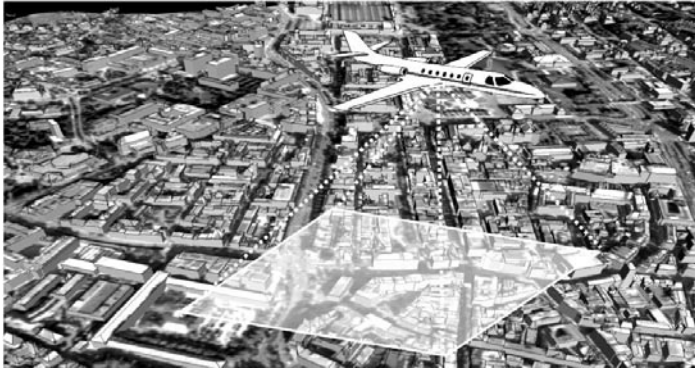
Abb. 10: Photo- grammetrische Bildaufzeichnung vom Flugzeug aus (Copyright: Institut für Photogrammetrie Universität Stuttgart)
