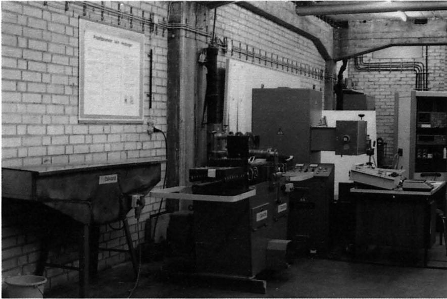
Abb. 6: Versuchstand zum Holzbiegen an der Universität Stuttgart mit Behälter zur Dampfplastifizierung (links), Biegemaschine (Mitte), HF-Generator mit angeflanschter Plastifiziereinheit (dahinter) sowie E-Modul-Prüfstand (rechts) mit FFT-Analysator.
