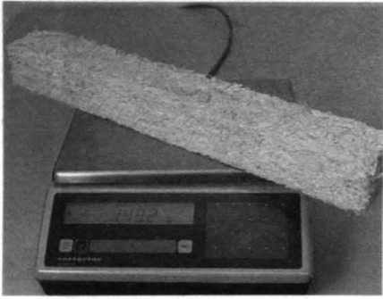
Abb. 11: Muster aus strukturierten dünnen Schneidspänen, Dichte 170 kg/m 3
