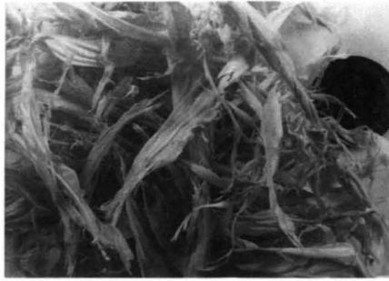
Abb. 8: Gedrehter bzw. gelockter Span ohne bzw. mit geringfügiger Knitterstruktur
