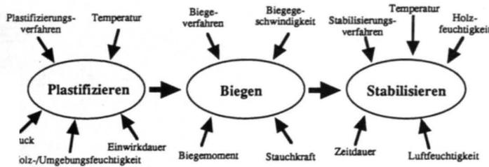
reißt (Buche plastifiziert etwa 1,6%). Dagegen nimmt der Werkstoff Stauchungen bis zu einer Höhe von etwa 30% auf, und setzt sie in eine Verdichtung der Zellen um. Holz behält im Stauchvorgang seinen Querschnitt demnach bei.
