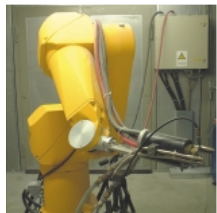
Abb. 2: Robotergestützte Anlage zum Plasmaspritzen (Anlage IFKB).
