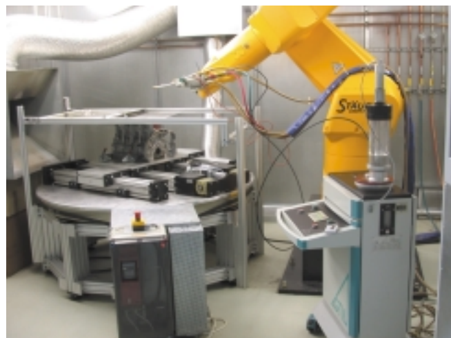
Abb. 16: Fertigungsstation zur Motorblockbeschichtung am IFKB. Zu erkennen sind der Drehtisch mit Maskiereinrichtungen, der Roboter und die Pulverfördereinheit.
