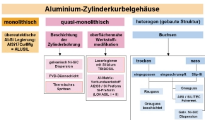
Abb. 12: Überblick über die verschiedenen Werkstoffkonzepte bei der Herstellung moderner Leichtmetallkurbelgehäuse.
