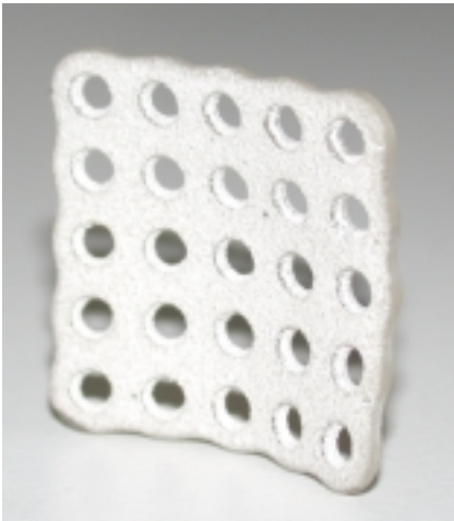
Abb. 26: TCP beschichtete PDLLA-Platte nach thermoplastischer Verformung bei 70°C, die Schicht wird durch die Verformung nicht beschädigt.
