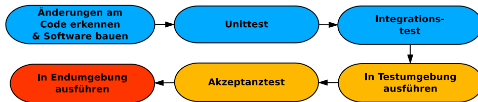
Abbildung 2.1.: Abgrenzung der Begriffe Continuous Integration , Continuous Delivery und Continuous Deployment , basierend auf [Pul13]. Continuous Integration besteht aus den Aufgaben in Blau, Continuous Delivery aus den blau und orange gefärbten und Continuous Deployment aus allen sechs Aufgaben.
