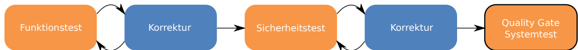
Abbildung 5.10.: Detailansicht der Systemtestphase mit den Entwicklungs- und Qualitätssicherungsaktivitäten Funktionstest, Korrektur der Befunde des Funktionstest, Sicherheitstest und Korrektur der Befunde des Sicherheitstests. Abgeschlossen wird die Phase durch ein Quality Gate.
