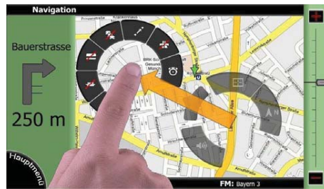
Abbildung 2.6.: Kreismenü zur Steuerung einer Navigation mithilfe von Wischgesten (Quelle: [11])
