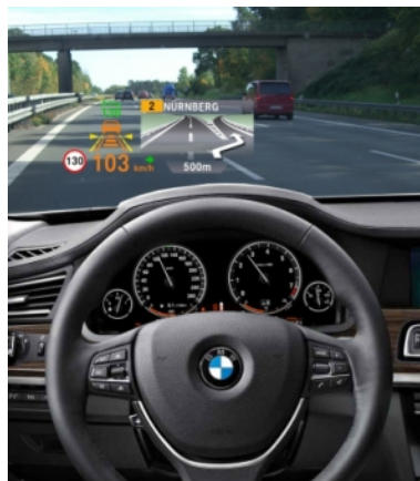
Abbildung 2.2.: Head-Up-Display zur Visualisierung der Navigation und wichtiger Verkehrshinweise (Quelle: BMW Group PressClub 1 )
