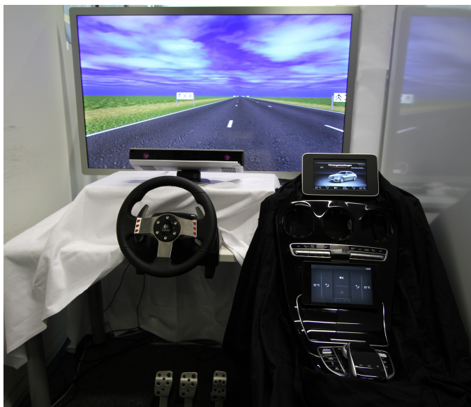
Abbildung 5.1.: Physischer Aufbau des Fahrsimulators unter Verwendung des entwickelten Prototyps, einem 55“ Zoll Monitor, dem Logitech G27 Racing Wheel-Paket und dem iViewX RED 250 Eye-Tracker
