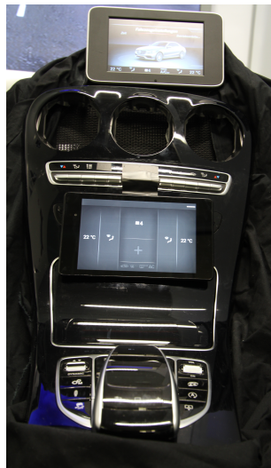
Abbildung 4.1.: Physischer Aufbau des Prototyps: Im unteren Bereich der Mittelkonsole wurde ein Android-Tablet als Demonstrator für einen Touch-Screen angebracht. Darüber zu sehen ist die traditionelle Klimabedienleiste. Am oberen Rand der Mittelkonsole wurde ein Head-Up-Display zur Anzeige aktueller Einstellungen montiert.
