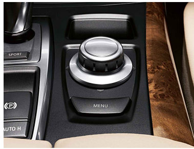
Abbildung 2.4.: BMW iDrive-Fernsteuerung in Form eines Dreh-Drückstellers sowie multifunktionalen Tasten (Quelle: [23])
