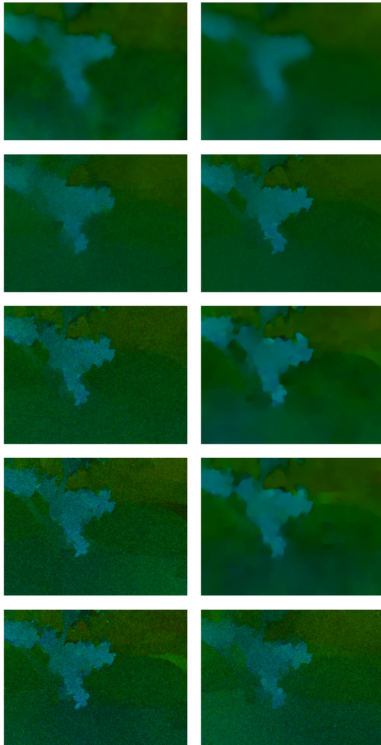
Abbildung 5.45: Vergleich der Flussfelder für die Grove2 Sequenz. Von oben nach unten: V_0^{s_\alpha} , V_1^{s_\alpha, n_s} , V_{2a}^{s_\alpha, n_s} , V_{2b}^{s_\alpha, n_s} und V_{2c}^{s_\alpha, n_s} mit \eta_w = 0.5 . Eingangsbilder werden mit additivem gaußischem Rauschen mit der Standardabweichung \sigma_n = 40 überlagert. Links \sigma_g = 0 , rechts \sigma_g = 4 . Eingangsbilder wurden mit dem Gaußfilter mit der Standardabweichung \sigma_g = 0 (links) und Standardabweichung \sigma_g = 4 (rechts) gefiltert.
