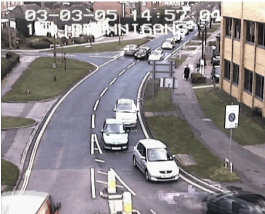
Abbildung 6.2.: Die Differenzen-Methode erzeugt bei langsameren Abspielgeschwindigkeiten häufiger unschöne Artefakte.
