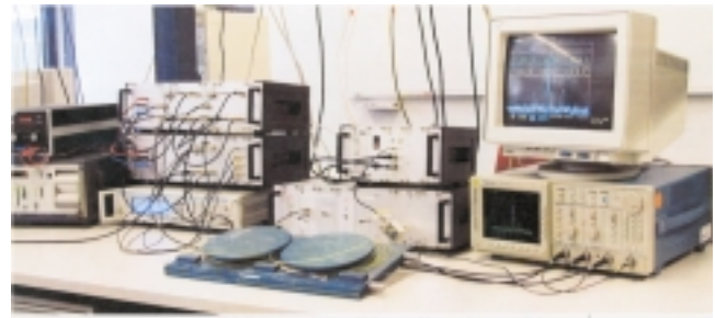
Abb. 15: Laboraufbau eines optischen Zugangsnetzes mit optischem CDMA. Im Vordergrund der optische Korrelationsempfänger, der kurze Einmoden-Glasfasern als Verzögerungsleitungen verwendet.
