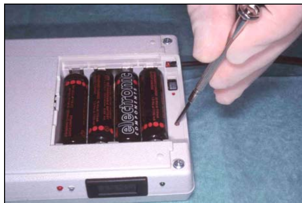
● Abbildung 3-48: Batteriefach mit der Möglichkeit der Sensorkalibrierung über ein Drehpotentiometer.
