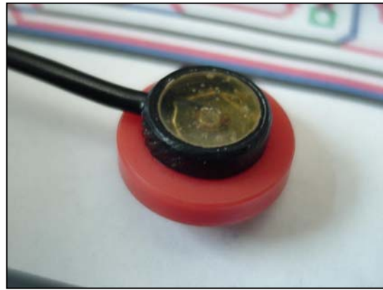
• Abbildung 3-2: ttcpO 2 Sensor von oben.
