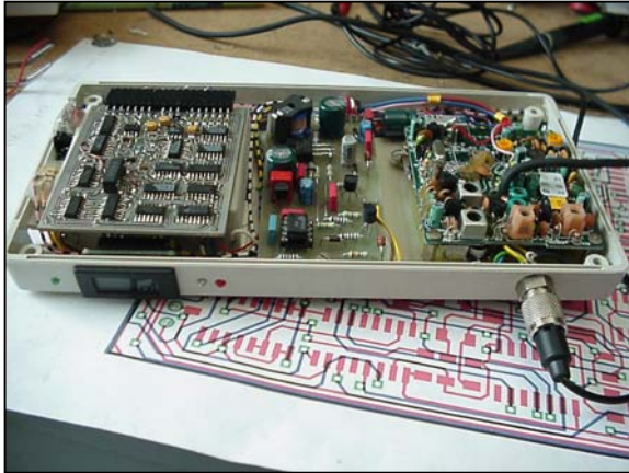
• Abbildung 3-9: Telemetrie-Sender: „Innenleben“.
