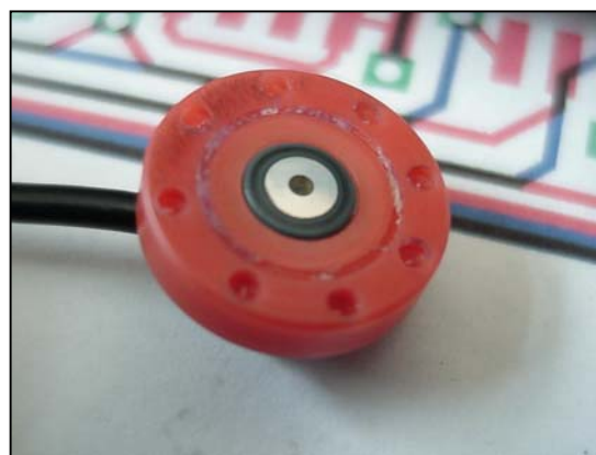
• Abbildung 3-3: ttcpO 2 Sensor von unten.
